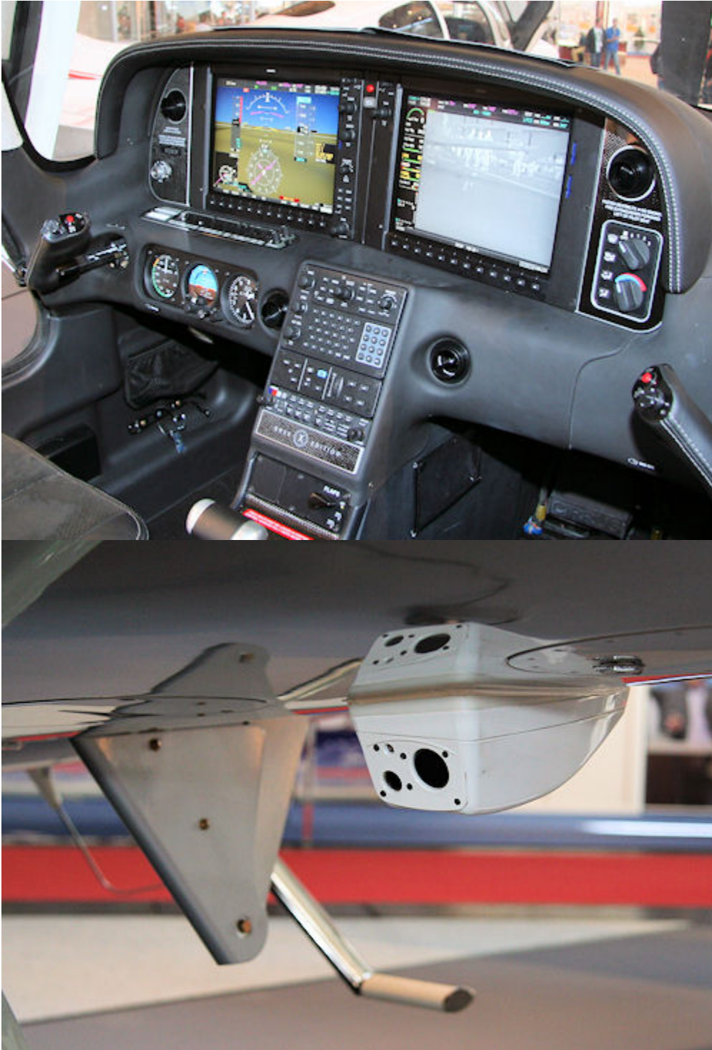
Obraz z kamery termowizyjnej wyświetlany na monitorze w kabine nowego Cirrusa oraz sama kamera zamontowana pod skrzydłem / Zdjęcia: Bartosz Głowacki
